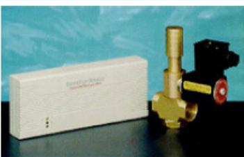
L'apparecchiatura consiste in un rilevatore di fughe di gas, il quale alla minima saturazione dell'ambiente blocca a monte il flusso del gas per mezzo dell'elettrovalvola e segnala visibilmente ed acusticamente all'esterno il sopravvenuto pericolo.
